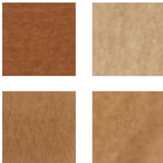
Varios tipos de papel después de ser impregnados con TP1 DVO® y sometidos a ruptura dieléctrica
